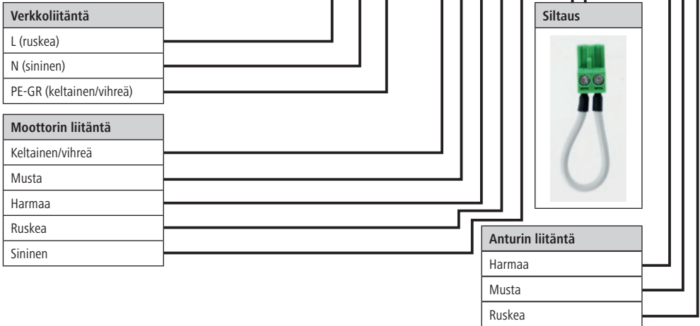
Kuva 8: Piirilevyn ja kondensaattorin kytkentäkaavio - MaxiSwing
